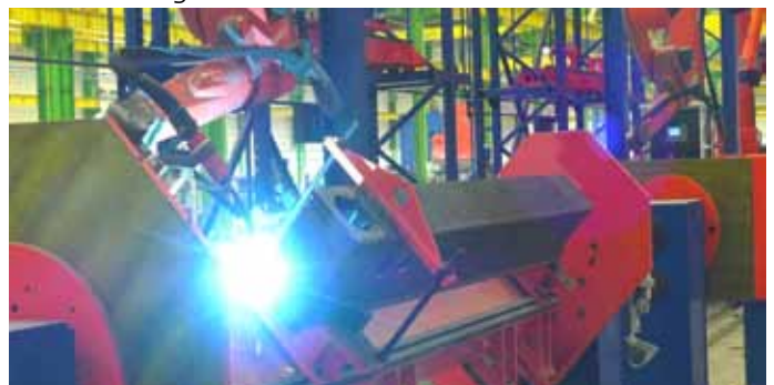
Bild 6: Auf der Anlage werden Kranstützen und kleinere Drehtürme geschweißt.
