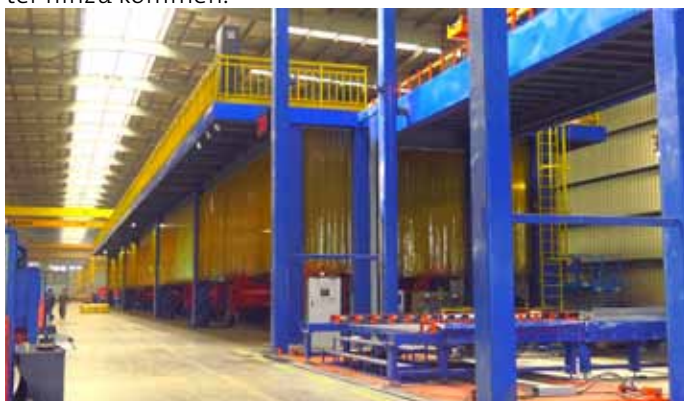
Bild 1: Die komplexe Roboteranlage zum Schweißen von Komponenten für Kippmulden besteht aus vier Schweißstationen mit insgesamt 12 Schweißrobotern.
