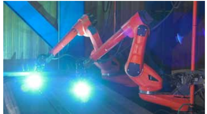
Bild 2: Die Knickarmroboter verfügen über eine Exzenterachse 7, die den Arbeitsbereich des Roboters erweitert und eine optimale Positionierung des Schweißbrenners erlaubt.
