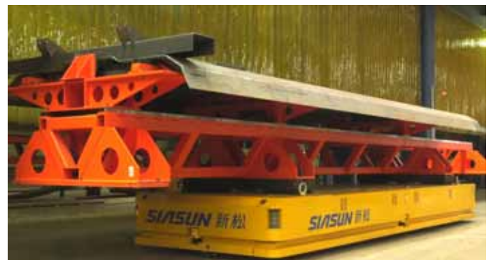
Bild 3: Fahrerlose Transportfahrzeuge transportieren die Vorrichtungen mit den Werkstücken zwischen den einzelnen Schweißstationen.
