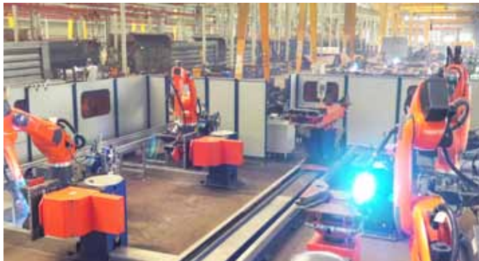
Bild 4: In einem weiteren verketteten System mit einem intelligenten Shuttlesystem schweißen fünf Schweißroboter mehr als 60 unterschiedliche kleinere Anbauteile und Zubehör für Lkw-Kipper.
