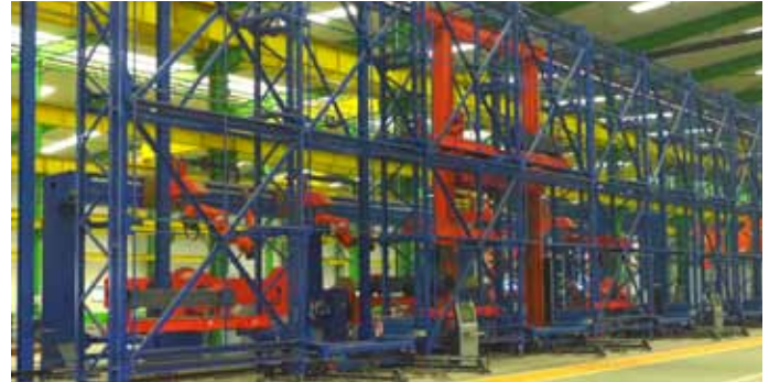
Bild 5: Eine weitere verkettete Anlage besteht aus vier Schweißrobotern und einem komplexen Lagersystem.
