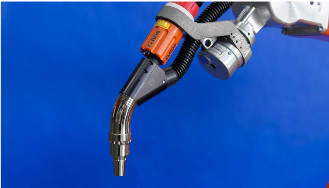
Bild 1: CLOOS bietet nun auch für das automatisierte Schweißen ein Absaug-Schweißbrennersystem an.
