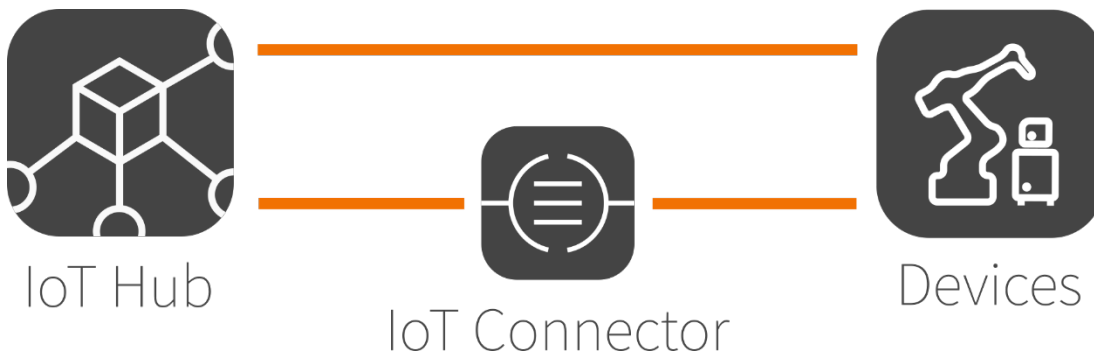
Bild 3: Die Geräte können entweder direkt mit dem IoT Hub oder mit einem zusätzlichen IoT Connector verbunden werden.
