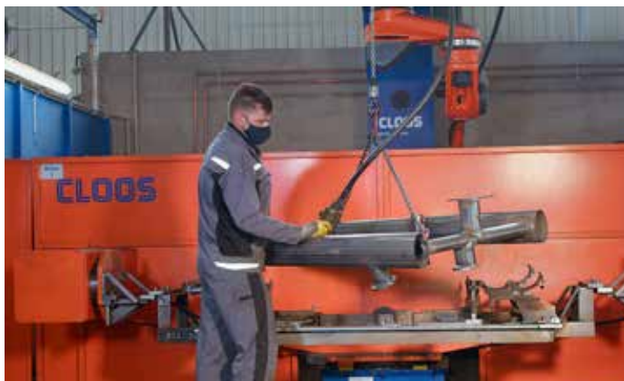
Bild 3: Während der Roboter schweißt, kann der Mitarbeiter die andere Station bestücken und entladen.
