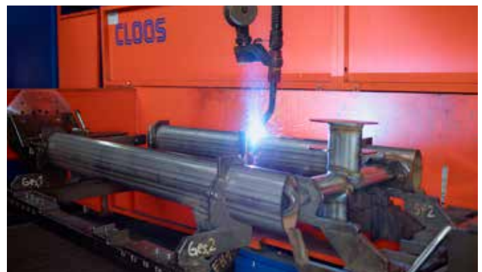
Bild 2: Rund 70 Prozent werden der Bauteile werden mittlerweile automatisch geschweißt.
