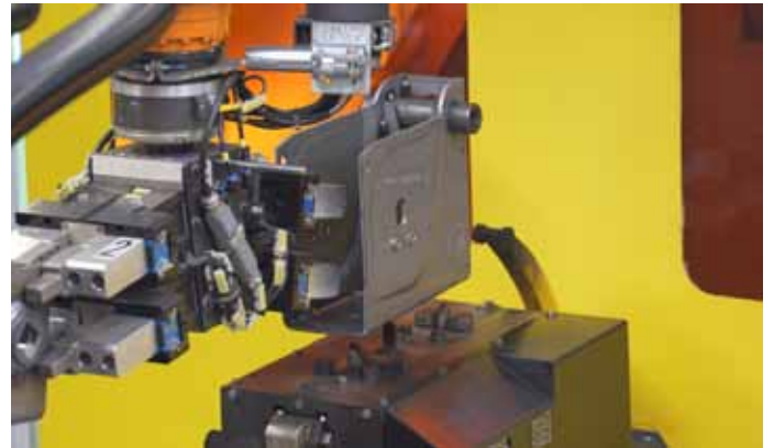
图2：搬运机器人全自动上下物料。
