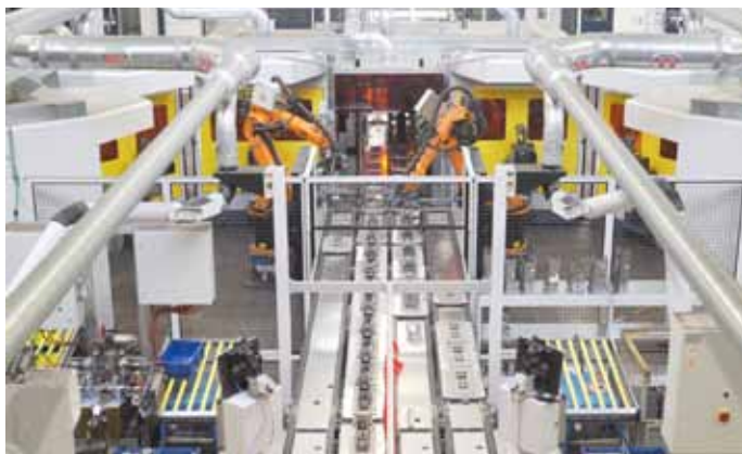
图1：内部物流系统完美配合焊接机器人
