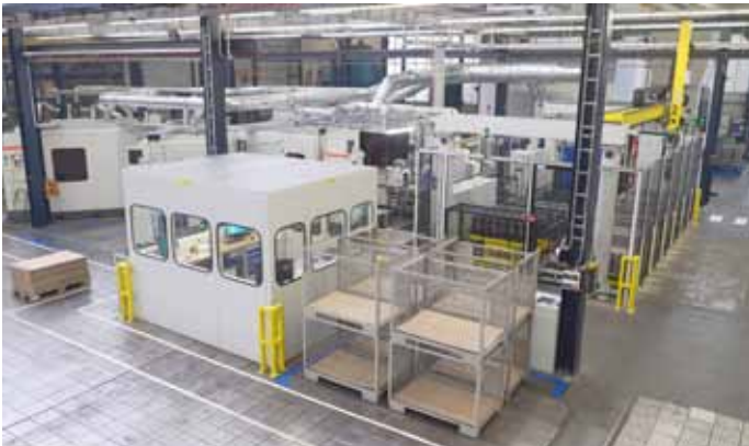
图5：焊接完成后，搬运机器人自动分拣成品。
