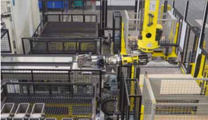
图4：焊接完成后，搬运机器人自动分拣成品。
