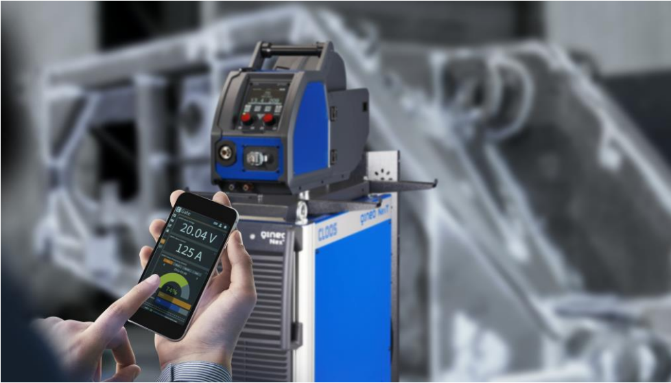
图 1: 通过 C-Gate 物联网 (IoT) 平台, 用户能够实时管理焊接生产数据。
