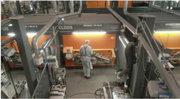
图3：双工位设计可以实现两个工位交替上料——整体流程时间显著减少。
