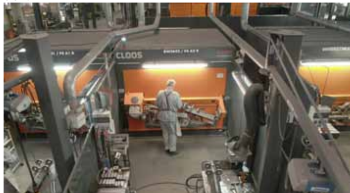
Bild 3: Durch den 2-Stationen-Aufbau können die Anlagen wechselseitig beschickt werden – ein enormer Zeitgewinn im gesamten Prozessablauf.
