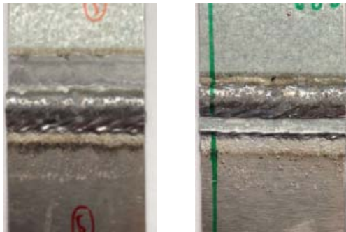
Abb. 10: Abscheren der Naht / Versagen in der WEZ
