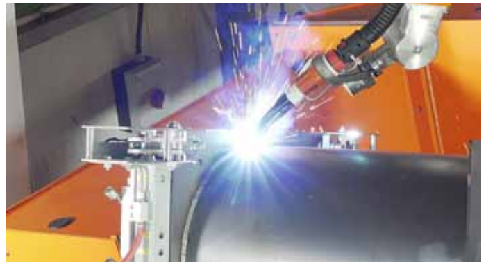
Bild 2: Bei „All in one“ verschmelzen Werkstückpositionierer, Roboter und Roboterpositionierer zu einer Einheit.
