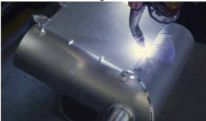
Bild 1: AKG France nutzt die CLOOS-Robotersystem zum Schweißen von kompletten Wärmetauschern, Trocknern und Kühlsystemen.
