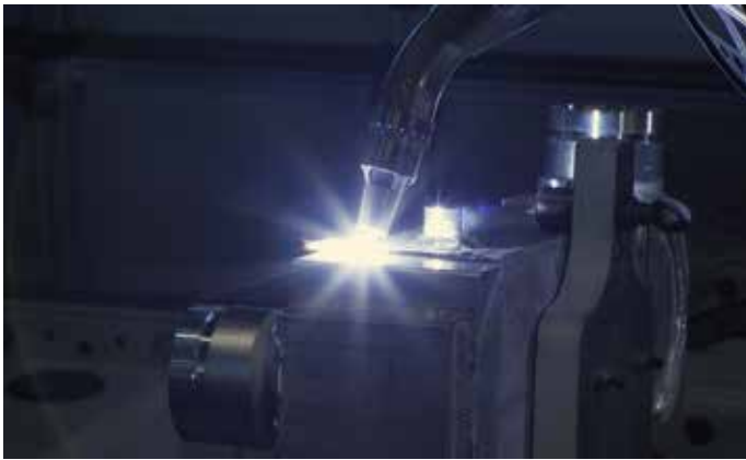
Bild 3: Der Schweißrauch wird direkt an der Quelle abgesaugt, sodass keine komplexe Filtereinrichtung notwendig ist.
