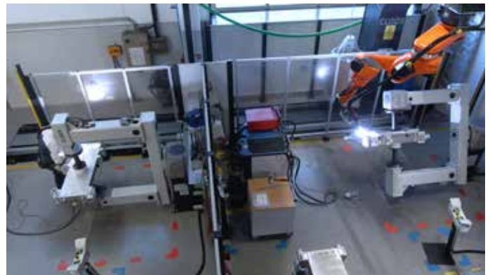
Bild 2: Die Anlage besteht aus zwei Stationen, sodass die Bauteilvorbereitung zeitgleich mit dem Schweißprozess stattfinden kann.
