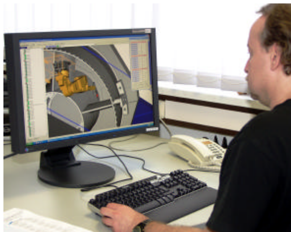
Anhand der Siemens-CAD-Bauteildaten erstellte CLOOS offline die Programmierung des Roboters.
