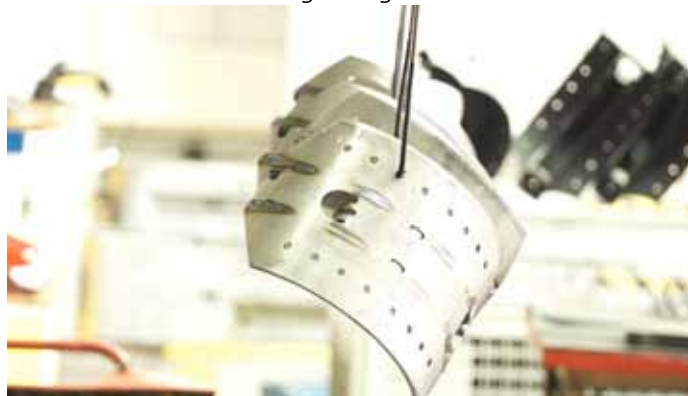
Bild 1: Im Bereich Komponentenfertigung schweißst eine CLOOS-Roboteranlage die Träger von Bremsbelägen für Trommelbremsen für LKW.
