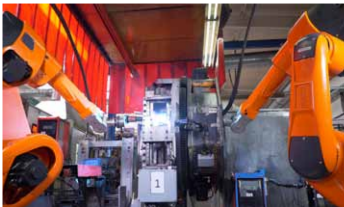
Bild 3: Die beiden alten Schweißroboter wurden durch zwei neue QIROX-Roboter QRC-350 ersetzt.
