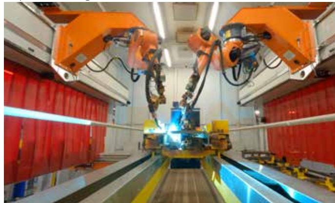
Bild 3: Zwei überkopf montierte QIROX-Schweißroboter QRC-350 übernehmen den Schweißprozess in der Fertigungslinie.
