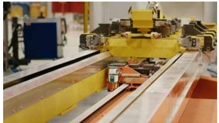
Bild 2: Die Vorrichtungen zur Aufnahme der Bauteile passen sich automatisch auf die unterschiedlichen Größen an.
