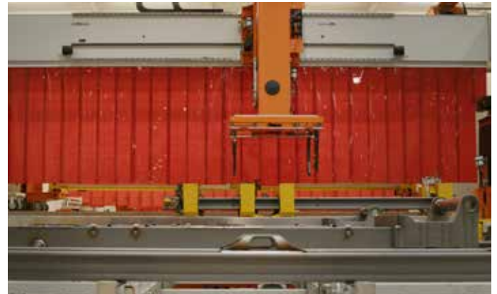
Bild 5: Der Greifer nimmt das geschweißte Bauteil von der Vorrichtung und legt es auf ein Auslauf-Förderband ab.
