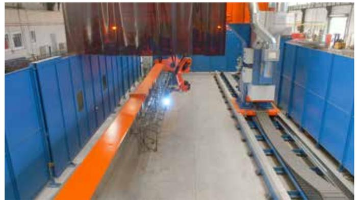
Bild 2: Der Roboter verfügt über einen stark erweiterten Arbeitsraum, da er über Kopf an einer Bodenfahrbahn mit Vertikal- und Horizontalhub montiert ist.
