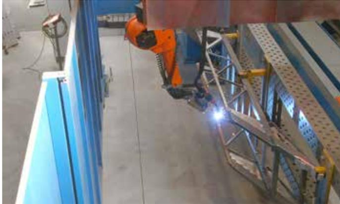
Bild 3: Eine weitere kompakte Roboteranlage schweißt Elemente für Korbmasträger und verschiedene Kleinteile.
