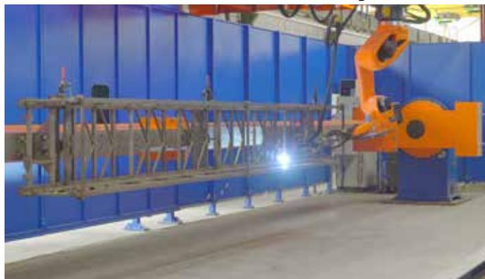
Bild 1: Zwei baugleiche Roboteranlagen schweißen Drehleiterelemente für Feuerwehrhubfahrzeuge.
