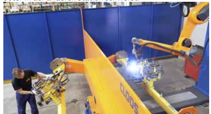
Bild 3: Der 2-Stationen-Aufbau ermöglicht das gleichzeitige Schweißen und Bestücken der Anlage.
