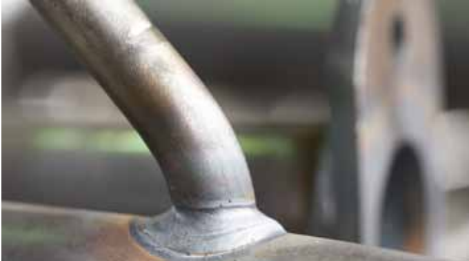
Bild 4: Durch den Einsatz der automatisierten Schweißtechnik erreicht der Anwender exakt reproduzierbare Schweißergebnisse.
