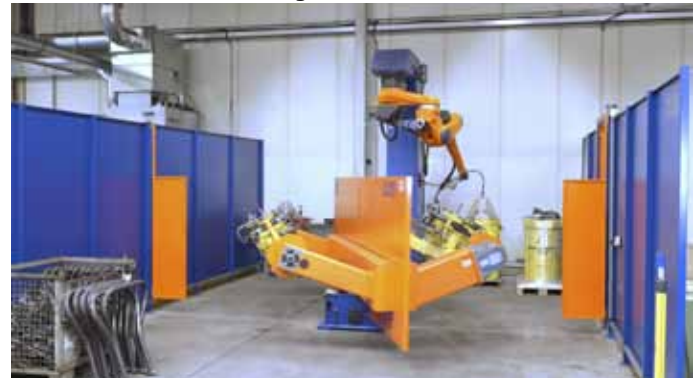
Bild 2: Der Stationswechsel beim Doppelstation-Werkstückpositionierer WP-DH-TC erfolgt durch eine horizontale Wendebewegung.
