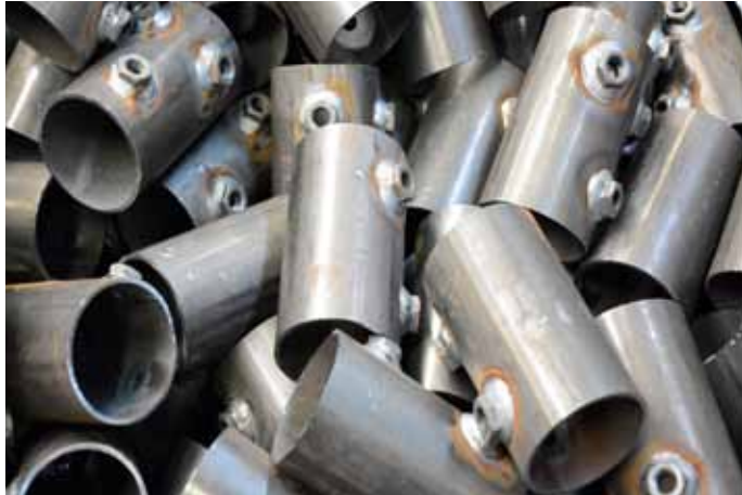
Bild 4: Die Kompaktzelle schweißt vor allem kleine Bauteile.
