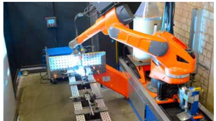
Bild 2: Bei „All in one“ sind alle relevanten Komponenten auf einem gemeinsamen Grundrahmen angeordnet.
