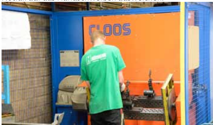
Bild 5: Der Bediener kann eine Station der Kompaktzelle bestücken, während auf der Roboter auf der anderen Station schweißt.
