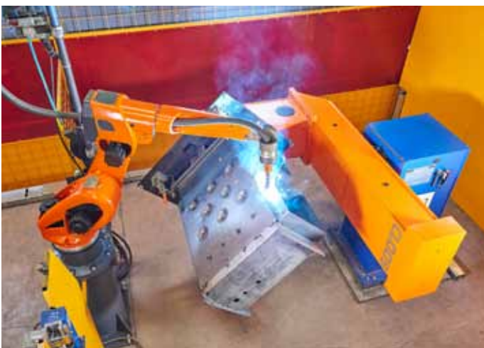
Der Werkstück-Positionierer WP-TS bringt den Kessel immer in eine für das Schweißen optimale Position.
