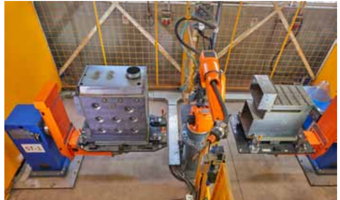
Der Zwei-Stationen-Aufbau der beiden Roboteranlagen beschleunigt den gesamten Prozessablauf enorm.
