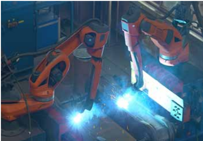
Bild 3: Die hohe Reichweite der jeweils siebenachsigen Schweißroboter vereinfacht das Schweißen der komplexen Werkstücke.
