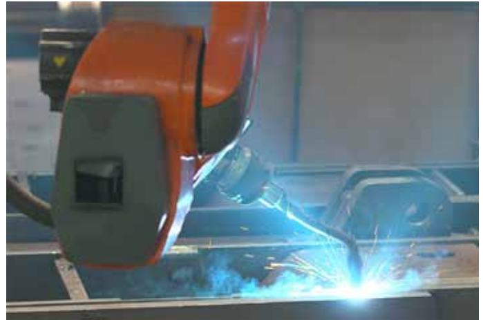
Bild 5: Durch den Einsatz der Schweißroboter erzielt das Unternehmen nun exakt reproduzierbare Schweißergebnisse.
