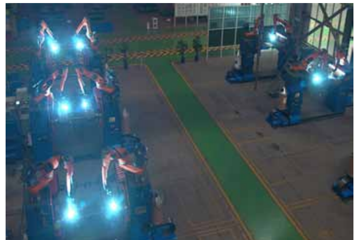
Bild 2: Das chinesische Unternehmen nutzt 25 CLOOS-Roboteranlagen für die Fertigung von hydraulischen Ausbauschilden.
