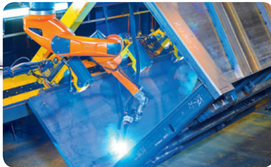
1996 übernahm CLOOS mit dem Tandem-Schweißverfahren eine Vorreiterrolle: Bei dem neuen Verfahren brennen zwei Lichtbögen in einem gemeinsamen Schmelzbad.
