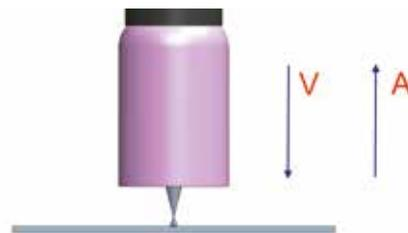
Dynamic Arc ermöglicht das Schweißen mit einem sehr kurzen Lichtbogen. Wenn sich die Elektrode dem Werkstück nähert, vermeidet die Stromerhöhung den Kontakt der Elektrode mit dem Schweißbad. Dieses verhindert das Verkleben der Elektrode mit dem Werkstück und die Wolframkontaminierung.
