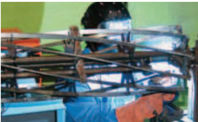
Beim MSG-Normalschweißen wird ein gleichmäßiger Lichtbogen erzeugt, der insbesondere beim Fügen von dünnwandigen Stählen von Vorteil ist. Fahrzeugbau, Elektroindustrie, Heiztechnik, weiße Ware und Möbelindustrie sind hierfür die klassischen Branchen. Außerdem wird insbesondere der Short Arc für das sichere Reparaturschweißen in allen Bereichen der Industrie genutzt und ermöglicht das Schweißen unter reinem CO<sub>2</sub>.
