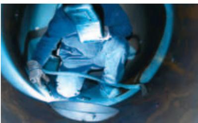
Der MSG-Pulsschweißprozess ist ideal für das Fügen von Bauteilen mit dünnen bis mitteldicken Wandstärken. Auch bei hohen Schweißgeschwindigkeiten werden gute Einbrandtiefen und Flankenverbindungen erzielt.
