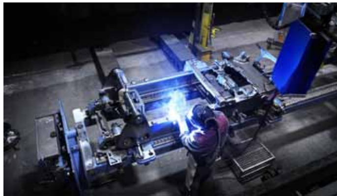
Bild 1: Im Bereich Hubmastfertigung nutzt Linde Material Handling seit kurzem neue Schweißstromquellen QINEO Next von CLOOS.
