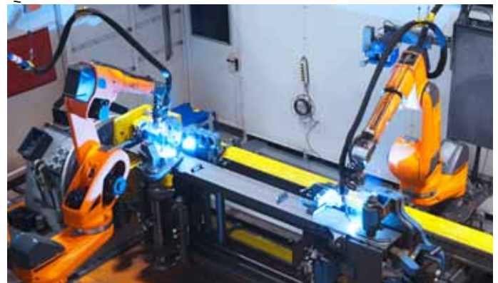
Bild 4: Neben den Handschweißgeräten setzt Linde Material Handling zahlreiche Roboteranlagen zum automatisierten Schweißen ein.
