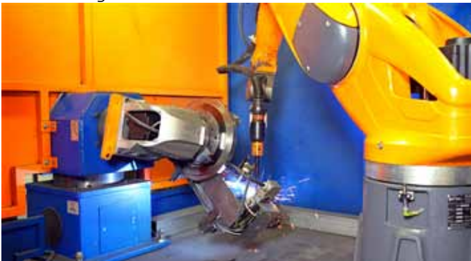
Bild 4: Der Werkzeugpositionierer bringt das Bauteil immer in eine optimale Schweißposition.
