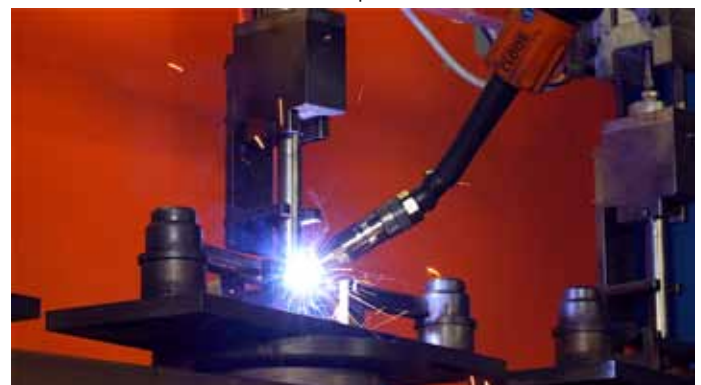
Bild 3: Die Schweißroboter gewährleisten eine gleichbleibende Prozessqualität.
