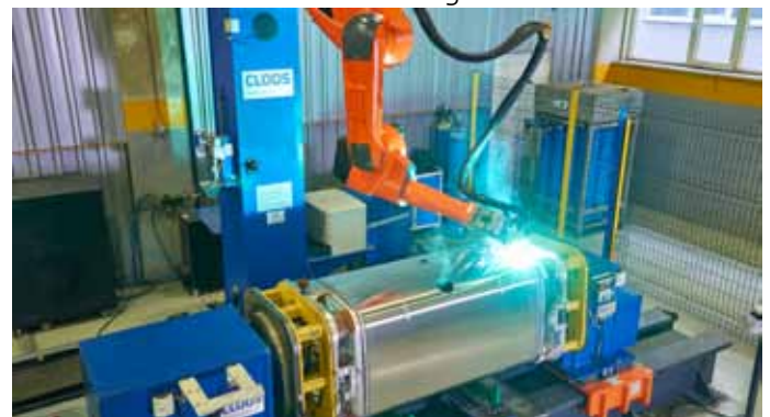
Die Überkopf-Position des Roboters ermöglicht eine optimale Werkstück-Zugänglichkeit.
