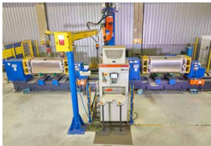
Die Roboteranlage besteht aus zwei Stationen, wo die Aluminium-Tanks parallel vorbereitet und geschweißt werden.
