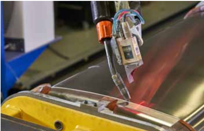
Der Laser-Online-Sensor CST Flex D führt Korrekturen direkt aus und gewährleistet optimale Schweißergebnisse.
