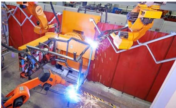
Die Werkstück-Positionierer – ausgestattet mit einer Wechsellösungsvorrichtung – bringen die Kabinen in eine für das Schweißen immer optimale Lage
