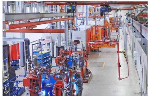
Die komplexe Fertigungslinie zum Verschweißen der Kabinen ist mehr als 70 Meter lang und besteht aus insgesamt zwölf Stationen.
