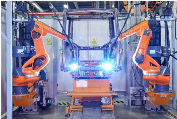
Nach dem Vorheften in den manuellen Stationen, verschweißen die 7-achsigen Roboter die Kabinen in den automatisierten Anlagen.
