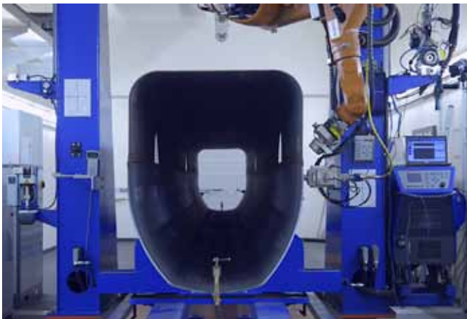
Automatisches Anreißen der Positionen für die Einbringung der Löcher erfolgt jetzt 80 Prozent schneller gegenüber manuellem Schneiden.
