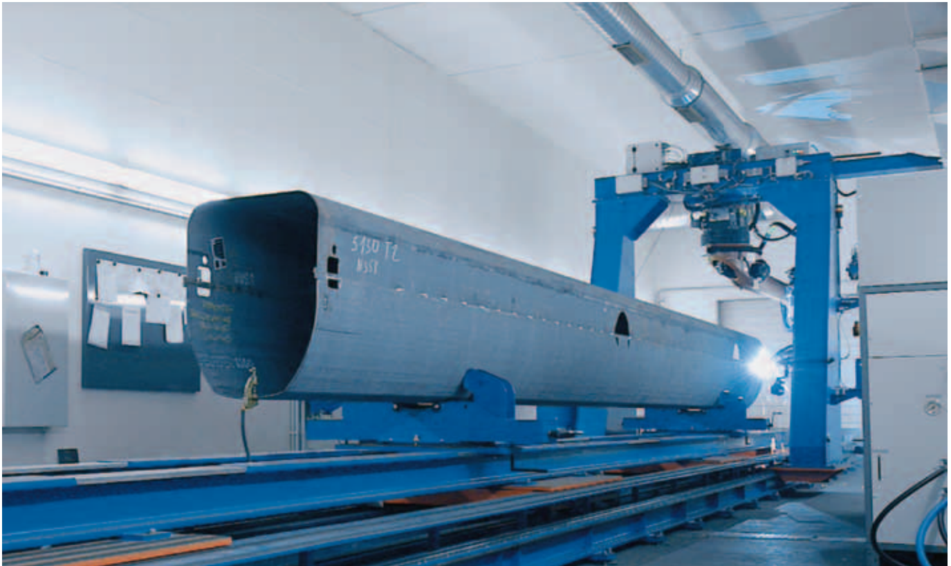
Der Ausleger eines Mobilkrans besteht aus dem Grundkörper und bis zu sechs Teleteilen, von denen jedes bis zu 14 m lang ist. Die untere Halbschale besteht aus einem stärkeren Blech als die obere. Hochfeste Feinkornstähle mit Materialstärken von 4 bis 15 mm werden dabei zu Auslegerteilen verarbeitet.
