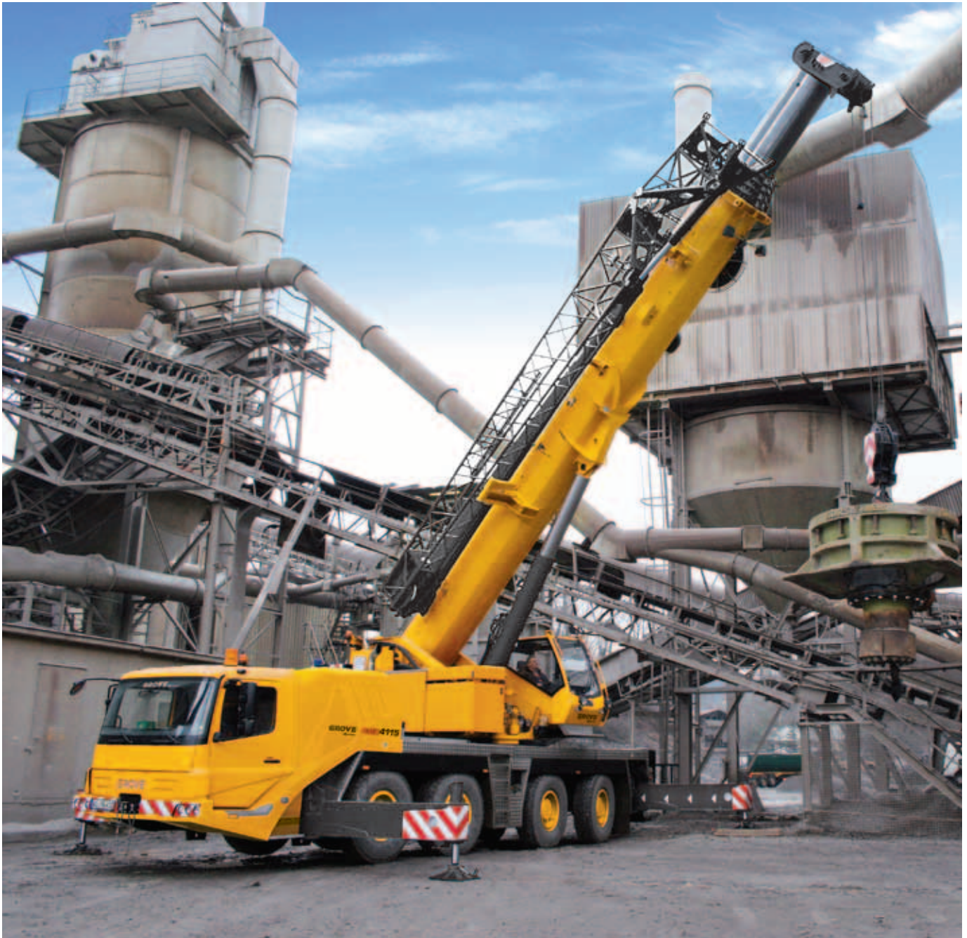
Der Grove Autokran GMK4115 mit 100 t Höchstlast, 11,3 m Auslegerlänge und einem Auslegerwinkel von -1,5^{\circ} bis max. +82^{\circ} .
