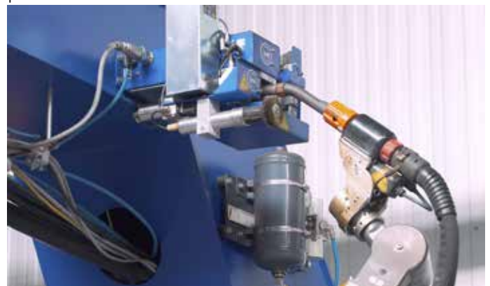
Bild 4: Die Roboteranlage beinhaltet auch eine vollautomatische Schweißbrennerreinigung.
