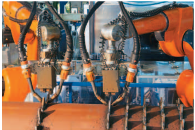
Zwei Roboter vom Typ QRC 350 holen die Zinken als Schüttgut automatisch ab und positionieren ihn optimal auf dem Bauteil
