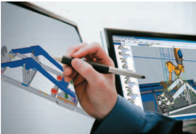
Programmierung des Frontladers mittels CLOOS Software Roboplan
