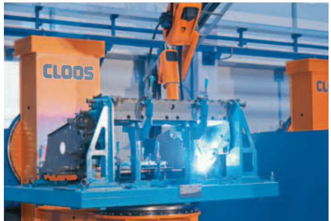
Optimale Zugänglichkeit des Bauteils durch exakte Positionierung von Bauteil und Roboter
