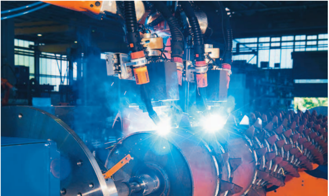
Die Schweißbrenner mit Greifersystem platzieren die Zinken auf der Walze und führen den Schweißprozess aus
