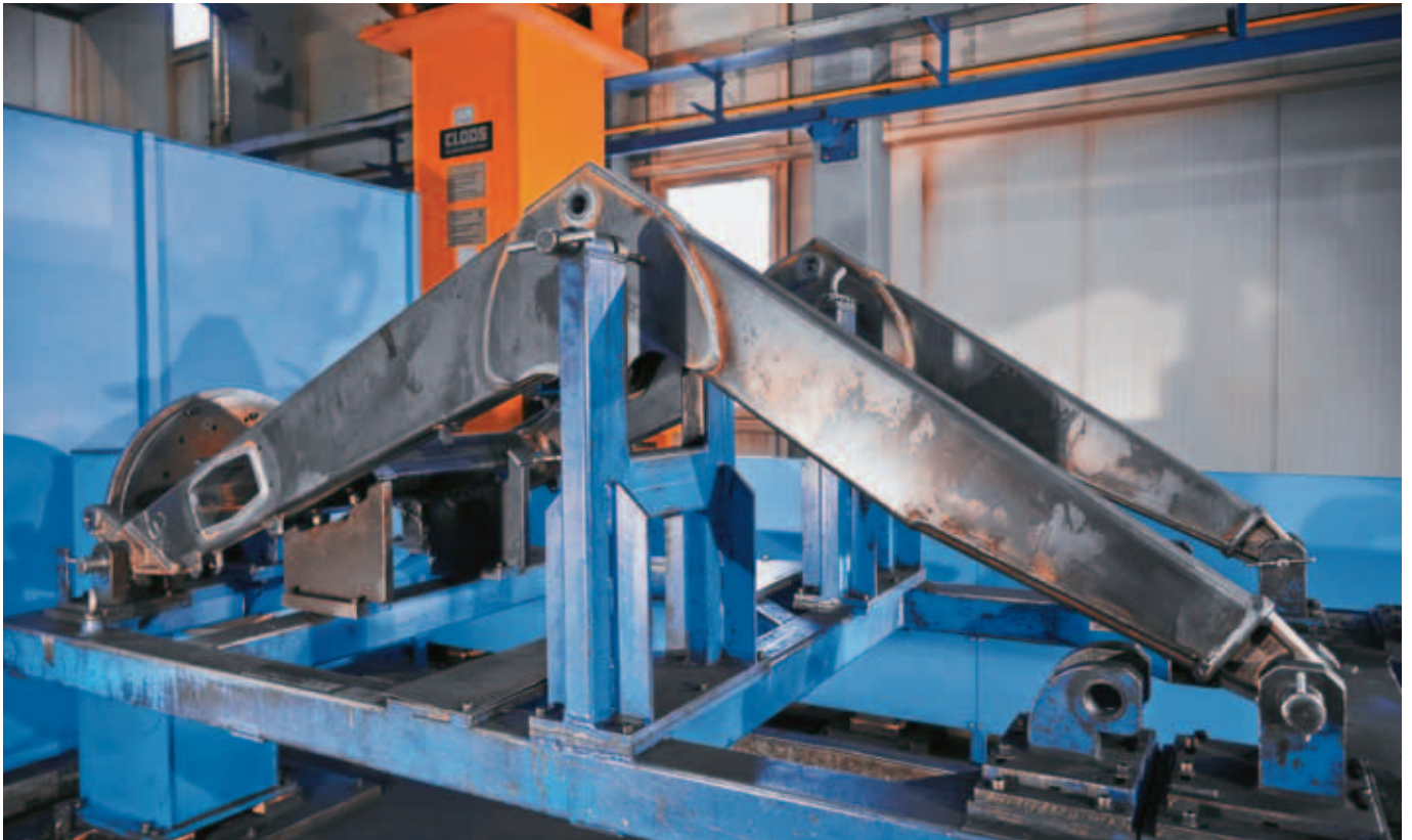
Die Schweißnähte des fertig geschweißten Frontladers erfüllen höchste Ansprüche an Zugfestigkeit bei gleichzeitig schöner Nahtoberfläche
