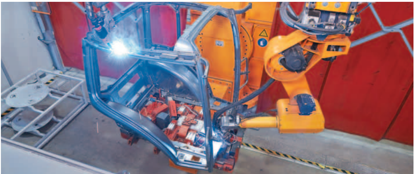
Die verschiedenen Kabinenvarianten können ohne einen Vorrichtungswchsel und ohne weitere Umbaumaßnahmen verschweißt werden
