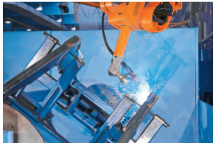
Positionierung des Bauteils in die optimale Schweißposition
